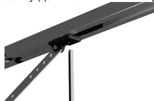
Рис. 13. Розблокування приводу за допомогою штока
